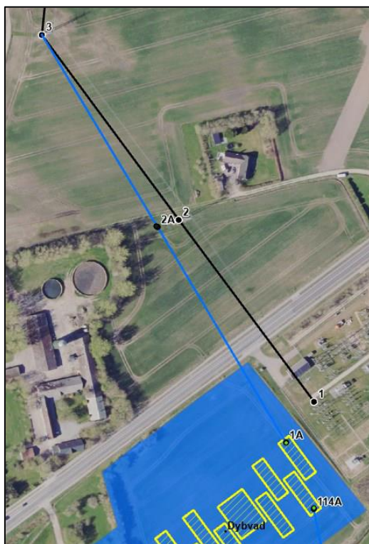
Figur 2-16: Indsløjfning af luftledning fra nord til Starbakke (SBA). Kilde: Energinets projektbeskrivelse.
