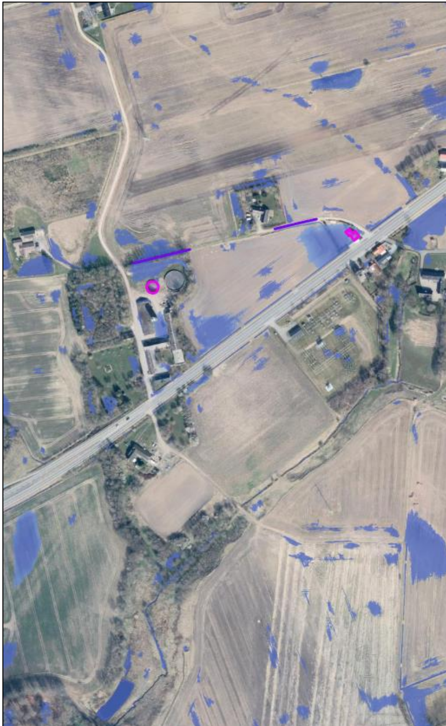
Figur 15-1: Illustration af bluespots (lavninger) med et afskæringskriterie på 20 cm. Bygninger og veje markeres i kortet ved nedbørsmængden på 90 mm, når disse potentielt bliver berørt af en 20 cm estimeret vanddybde mindre end 0,5 m fra den offentligt registrerede bygningsplacering. Kilde: KAMP.
